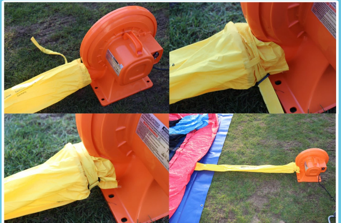
LÜFTER AUFSTELLEN, SCHLAUCH KORREKT BEFESTIGEN
